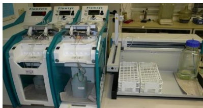
Nährstoffanalysator für Phosphat, Nitrat und Ammonium.
