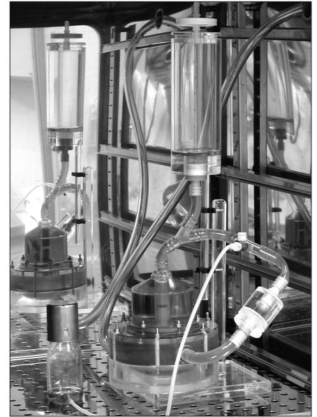
Abb. 1 Bioreaktor für Zellbesiedlung unter pulsatilen Bedingungen
