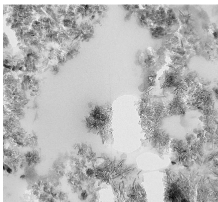
Abb. 2: TEM Aufnahme des Biomaterials mit einer lockeren Kristallgefüge. Die untere Bildkante beträgt 2 \mu\text{m} . TEM image of the biomaterial with an open crystal structure (figure edge is 2 \mu\text{m} ).
