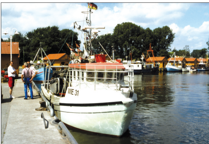
Abb. 2 (oben): Hölzerner Kutter TAR-006 "Uschi" des Tarnewitzer Fischers Uwe Dunkelmann, erbaut 1989 in Kirchdorf/Poel; Motor: Luckenwalder W 50, Nachrüstungen: Dem Netzholer folgten 1994 GPS-Navigationsgerät, UKW-Sprechfunk und Echograph mit Fischfinder, 1997 das Radargerät; "... die technische Ausrüstung vor 1990 war Null." (Tarnewitz, 1999).
