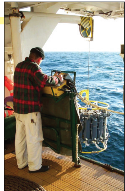
Abb. 6: Arbeiten mit einem vertikal sondierenden Mess-System mit Wasserschöpferkranz an Bord des Forschungsschiff «A. v. Humboldt».
