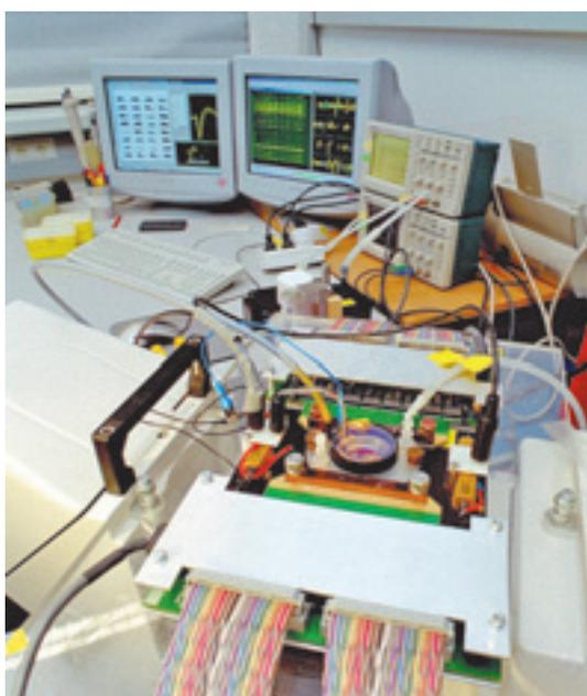
Mikro-Elektroden-Array-Messstation. Ableitung der elektrischen Nervenzell-Aktivität aus der Zellkulturkammer über 64 Vorverstärker (Abb. 3)
