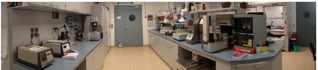
Betriebsstofflabor, mit Messplätzen zur normgerechten Bestimmung von Kraft- und Schmierstoffkennwerten
