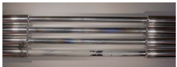
Abbildung 3: Seifenartige Ablagerungen auf Aluminium-Heizstäben
