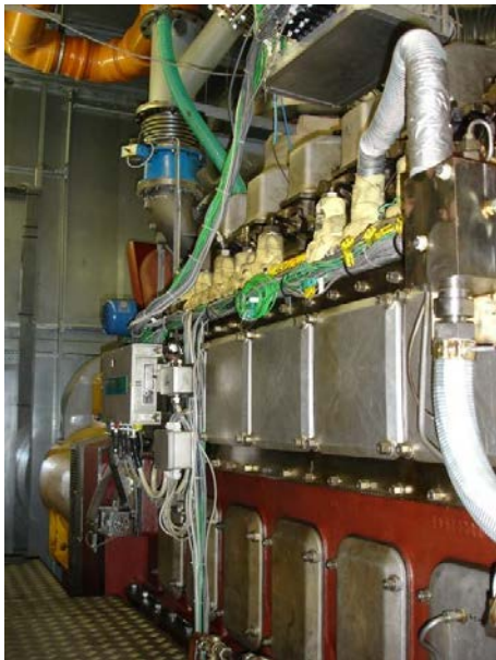
Versuchsträger: Caterpillar MaK 6M20 mit Common-Rail-Einspritzsystem
