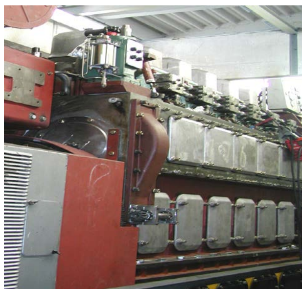
Schweröltauglicher Motor 6M20
