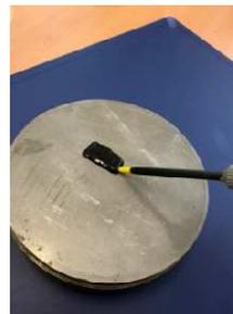
(1) Proben diverser Gleitlagerbeschichtungen (2) negativer Silikonabdruck von einem Gleitstein
