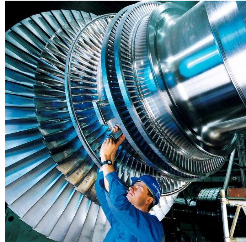
Trommelstufen mit Trommelläufer Parsons-Bauweise, Überdruckwirkung, mit Randabdeckung an den vorderen Laufschaufeln
