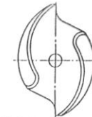
Bild 11: Offenes Zweikanalrad mit S-förmigen Schaufeln
