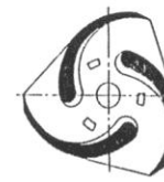
Bild 12: Geschlossenes Dreikanalrad (Draufsicht ohne Deckscheibe dargestellt)
