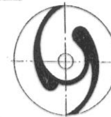
Bild 9: Geschlossenes Einkanalrad (Draufsicht ohne Deckscheibe dargestellt)
