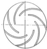
Bild 1: Radialrad mit rein radialen Schaufeln, Staupunkt S (Draufsicht ohne vordere Deckscheibe dargestellt)
