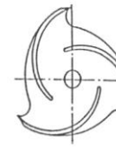
Bild 13: Offenes Dreikanalrad mit zylindrischen Schaufeln
