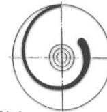
Bild 7: Geschlossenes Einschufelrad (Draufsicht ohne Deckscheibe dargestellt)
