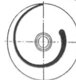
Bild 7: Geschlossenes Einschufelrad (Draufsicht ohne Deckscheibe dargestellt)
