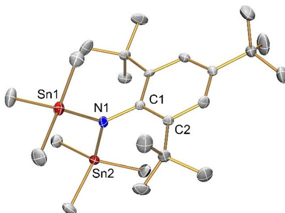
**Abbildung 31:** Molekülstruktur von **16**. Thermische Ellipsoide entsprechen 50% der Wahrscheinlichkeit bei 123(2) K (H-Atome nicht dargestellt). Ausgesuchte Bindungslängen (Å) und Winkel (°): N1-Sn1 2.060(2), N1-Sn2 2.069(2), N1-C1 1.449(4), C1-N1-Sn1 120.8(2), C1-N1-Sn2 120.7(2), Sn1-N1-Sn2 118.4(1), Sn1-N1-C1-C2 84.7(3).
