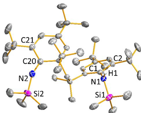
**Abbildung 7:** Darstellung der Molekülstruktur von **3**. Thermische Ellipsoide entsprechen 50% der Wahrscheinlichkeit bei 123(2) K (H-Atome, außer H1, nicht dargestellt). Ausgesuchte Bindungslängen (Å) und Winkel (°): Si1-N1 1.734(3), Si2-N2 1.701(3), N1-C1 1.435(3), N2-C20 1.274(4); C1-N1-Si1 133.1(2), C20-N2-Si2 160.7(2); Si1-N1-C1-C2 -96.1(3), Si2-N2-C20-C21 160.3(6).
