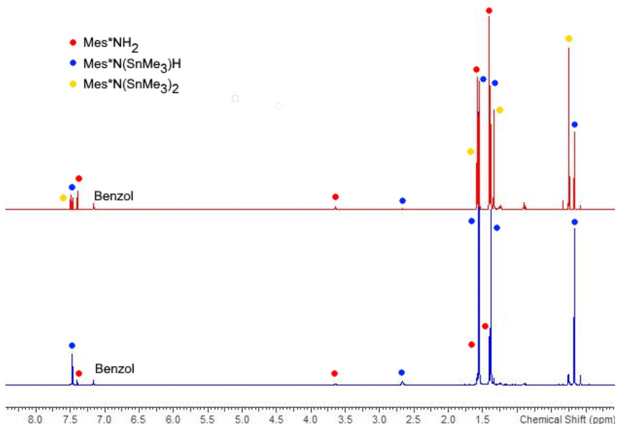
**Abbildung 30:** Synthese von **13** mit Filtration über eine basische Fritte (rot) und mit Filtration über eine neutralisierte Fritte (blau).
