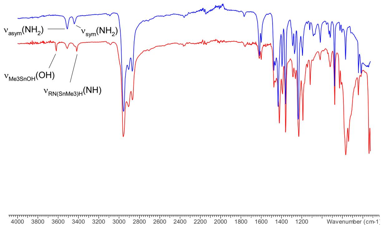
**Abbildung 22:** IR-Spektrum von Mes\*NH<sub>2</sub> (blau) und von **13** mit teilweiser Hydrolyse zu Mes\*NH<sub>2</sub> und Me<sub>3</sub>SnOH (rot).
