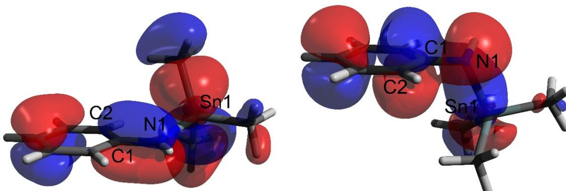
**Abbildung 29:** MO (HOMO-2) von  $\text{PhN}(\text{SnMe}_3)\text{H}$  für die Situation  $\text{Sn1-N1-C1-C2} = 20.9^\circ$  (links, optimierte Struktur) und MO (HOMO) für die Situation  $\text{Sn1-N1-C1-C2} = 90.0^\circ$  (rechts, *single-point*-Rechnung).
