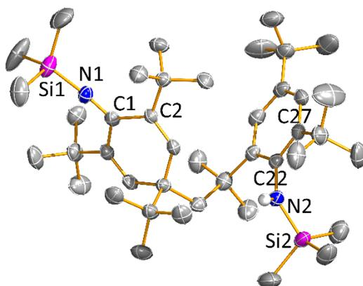
**Abbildung 1:** Darstellung der Molekülstruktur von **2** ( $Cc$ ).<sup>[17]</sup> Thermische Ellipsoide entsprechen 50% der Wahrscheinlichkeit bei 173(2) K (H-Atome, außer H1, nicht dargestellt). Ausgesuchte Bindungslängen (Å) und Winkel (°): Si1-N1 1.6885(2), Si2-N2 1.7317(2), C1-N1 1.268(2), C22-N2 1.438(2); C1-N1-Si1 175.8(2), C22-N2-Si2 135.2(1); C2-C1-N1-Si1 43(2), Si2-N2-C22-C27 86.7(2).
