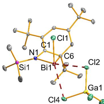
**Abbildung 9:** Darstellung der Molekülstruktur von **4**. Thermische Ellipsoide entsprechen 50% der Wahrscheinlichkeit bei 123(2) K (H-Atome nicht dargestellt). Ausgesuchte Bindungslängen (Å) und Winkel (°): Bi1-N1 2.315(2), Bi1-Cl1 2.4819(7), Bi1-C1 2.707(3), Bi1-C6 2.348(3), Bi1-Cl2 3.1048(8), Bi1-Cl4 3.3427(8), C1-N1 1.326(3); N1-Bi1-Cl1 89.25(6), N1-Bi1-C6 60.78(9), C6-Bi1-Cl1 91.38(7).
