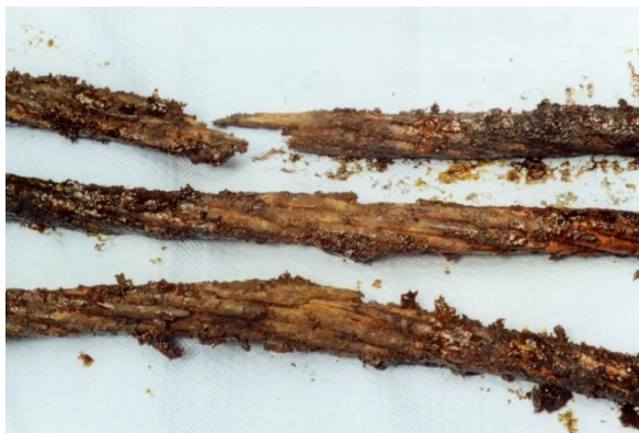
Korrosion Auflösen von Metallen 4 \text{ Fe} + 3 \text{ O}_2 \rightarrow 2 \text{ Fe}_2\text{O}_3
