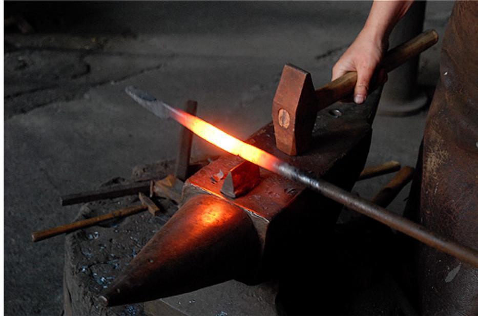
Die Duktilität (Plastische Verformbarkeit) von Metallen (Ziehen, Walzen, Hämmern) beruht darauf, dass in ausgezeichneten Atomebenen eine Gleitung möglich ist. In der kubisch flächenzentrierten Struktur (fcc) existieren mehr Gleitebenen als in der hexagonal dichtesten Packung (hcp) oder der kubisch innenzentrierten Packung.
