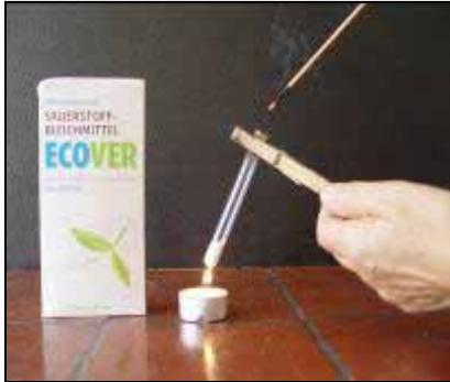
Anstelle von Kaliumpermanganat kann ein fester **Oxi-Reiniger** erhitzt werden. Als Wärmequelle reicht ein Teelicht. Der entstehende Sauerstoff wird mit der Spanprobe nachgewiesen.
