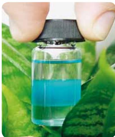
Abbildung 1: 3-Phasen-System mit ionischer Flüssigkeit
