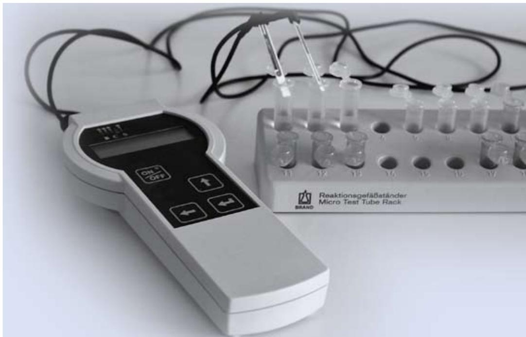
Sensoren mit Handmessgerät für Vor-Ort-Untersuchungen
