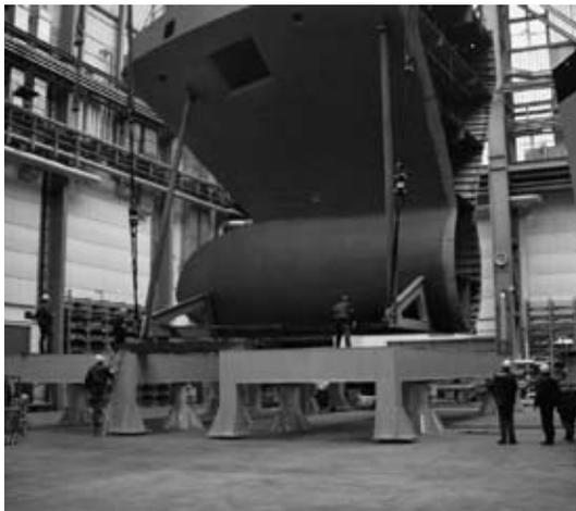
Ablage auf Traversenkonstruktion
