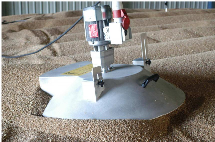
Abbildung 1: Damit der Roboter der Wellenbrock Getreidetechnik im Silo zielsicher umherfahren kann, muss seine Position im Silo bestimmbar sein.
