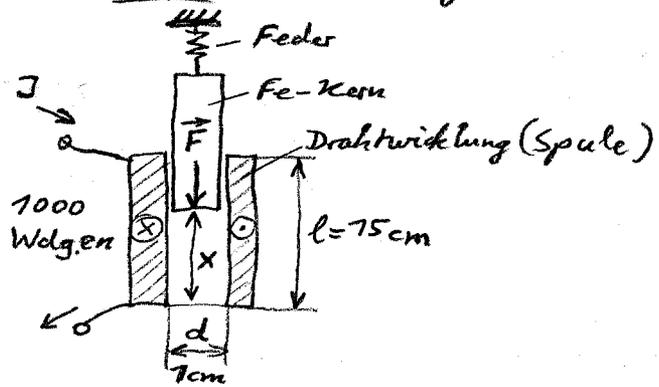
ges: Zugspannung  $\sigma = f(x)$
