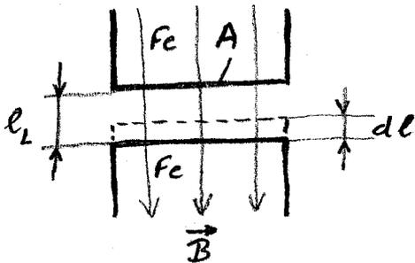
bei Verringerung der Luftspaltlänge  $l_L$  um  $dl$  wird mechanische Arbeit
