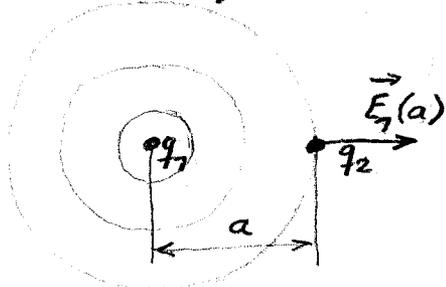
Verschiebungsdichte  $D_1 = \frac{q_1}{4\pi a^2}$
