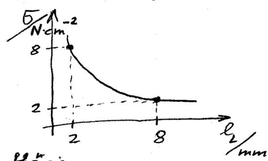
Allg: Zugspannung  $\sigma$  nur von magn. Feldgrößen abhängig
