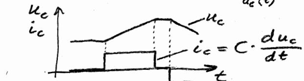
$\Rightarrow$  In differenziell kurzen Zeiten bleibt Spannung am  $C$  konstant!
