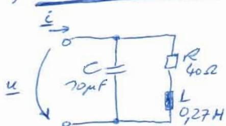
$$\begin{aligned} \underline{Y} &= j\omega C + \frac{1}{R + j\omega L} \\ &= j\omega C + \frac{R - j\omega L}{R^2 + (\omega L)^2} \end{aligned} \quad \begin{array}{l} \text{Konjugiert komplexe} \\ \text{Erweiterung} \end{array}$$
