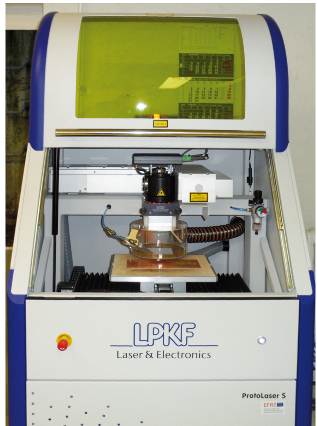
Abb. 3: Laserbearbeitung von Leiterplatten
