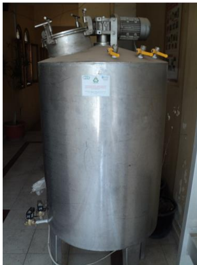
Abbildung 14: Ethanolversuchsreaktor, 300 l Volumen
