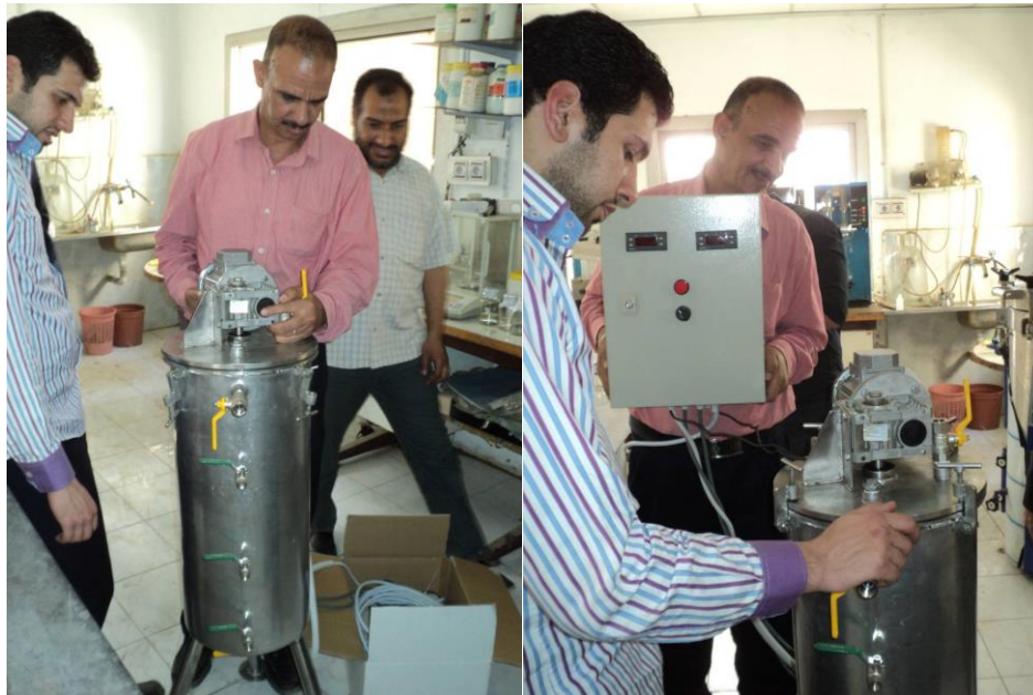
Abbildung 13: Laborreaktor zur Ethanolproduktion, 20 l Volumen
